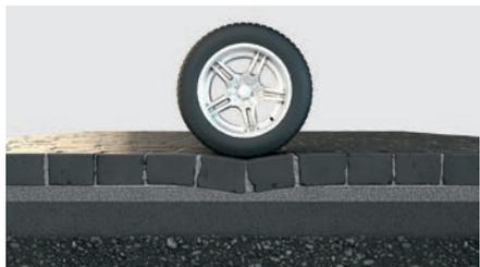
Односторонние нагрузки на край элемента покрытия вызывают в нем напряжения. При проезде по поверхности усилия могут воздействовать на отдельные камни брусчатки.
