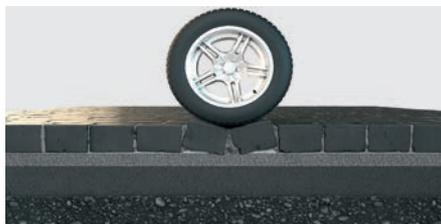
Только сцепление между покрытием и подстилающим слоем не может предотвратить подъем покрытия.
